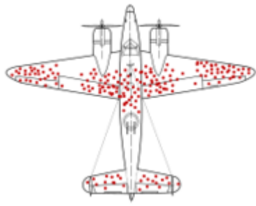
図 6.生還航空機の損害状況。赤点が損害箇所を示すが、生存者バイアスを考慮すればむしろ無印の部分が補強すべき最も重要な部位であることになる。
